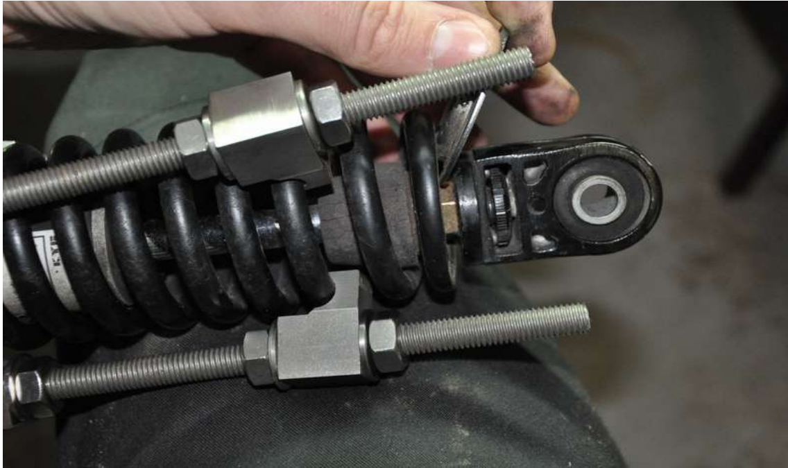
3 – Retirer le demi-siège, le ressort, la rondelle d'appui et les bagues de réglage
